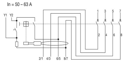
\* Die DS 200 50 A und 63 A-Ausführungen besitzen 2 zusätzliche Klemmen Y1 und Y2 parallel zur Prüftaste (zur Fernauslösung der FI/LS).
